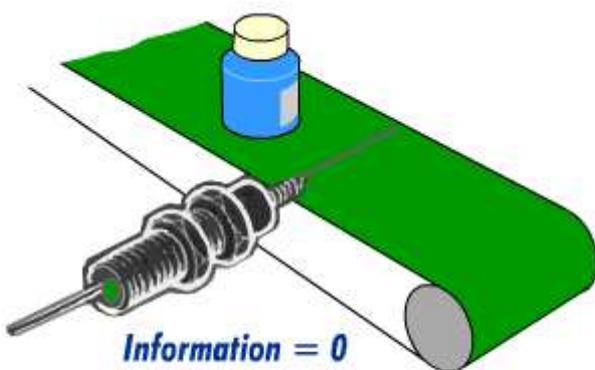
**Détection de passage d'un flacon**
