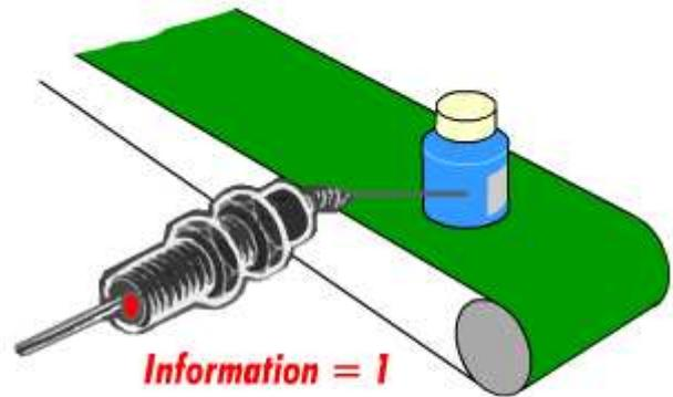
**Détection de passage d'un flacon**
