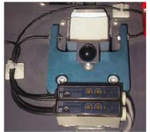
Détection des mousses Système barrage (Ermet)
