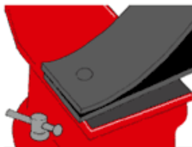
4 - Enfiler le rivet dans les trous d'assemblage et poser la tête du rivet en appui sur une surface dure (table d'un étau, enclume, morceau de bois dur...).
