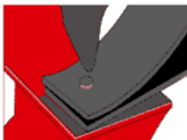
5 - Avec la panne du marteau de mécanicien (ou marteau rivoir), écraser les bords de la tige du rivet.
